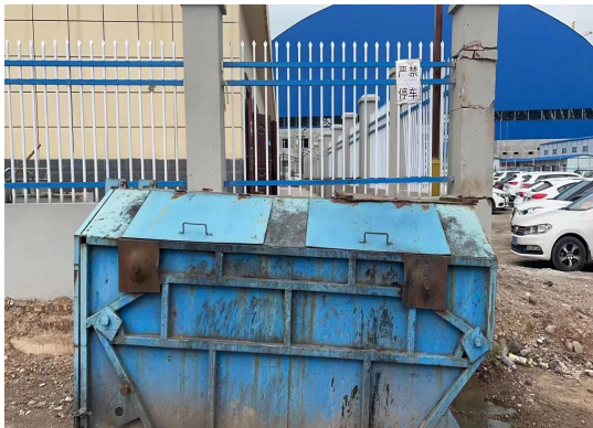
污泥暂存装置
