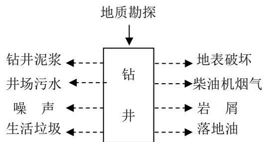
图 2 钻探井工艺流程及产污节点图
